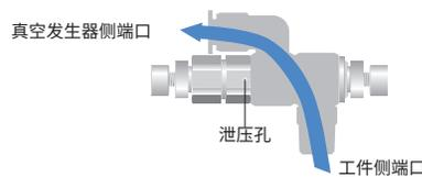
真空从工件侧端口流入, 以同等流量从真空发生器侧端口排出。
