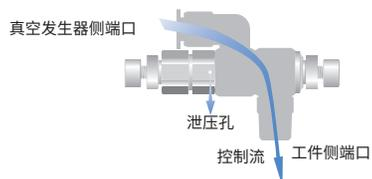
真空破坏气流从真空发生器侧导入被控制流量后, 从工件侧端口以及泄压孔排出。
