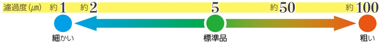
細かい濾過度：約1 $\mu$ m, 約2 $\mu$ mの用途
