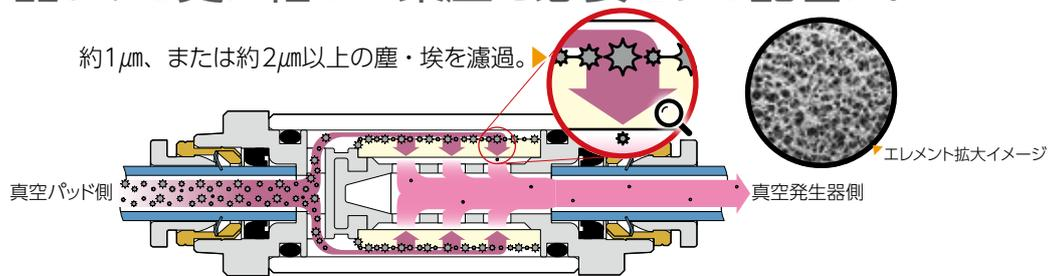
粗い濾過度：約50 $\mu$ m, 約100 $\mu$ mの用途
